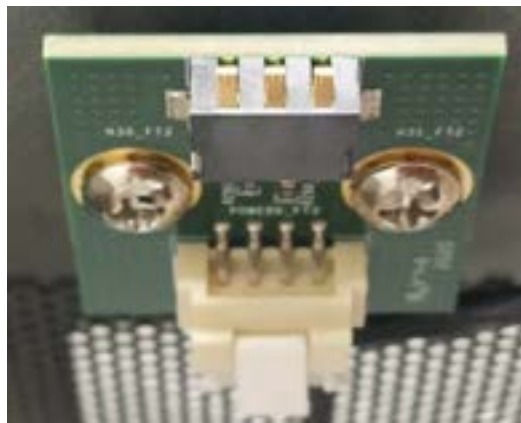
Fan Power Connector on GEB-3601-R10
