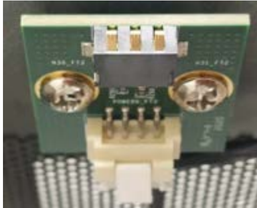
Fan Power Connector on GEB-3601-R10
